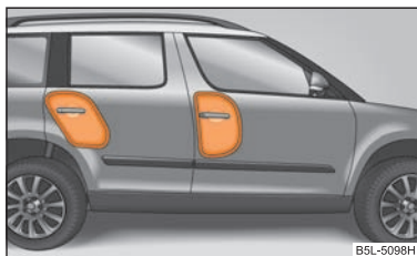
Изобр. 134 Раздутая боковая подушка безопасности, заполненная газом
