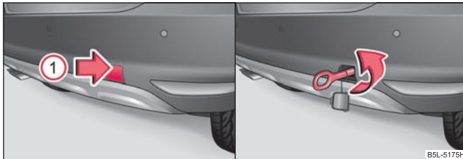
Изобр. 183 Задний бампер: демонтаж крышки / установка буксирной петли
