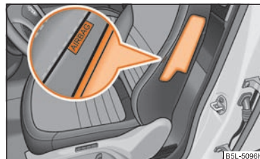
Изобр. 133 Местоположение боковых надувных подушек безопасности в сиденье водителя
