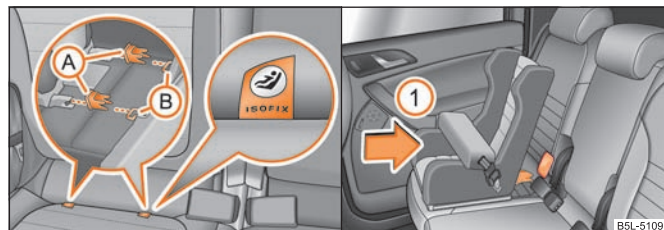
Изобр. 144 Ушки крепления (система ISOFIX) / детское сиденье с системой ISOFIX вставляется в установленные приемные пазы
