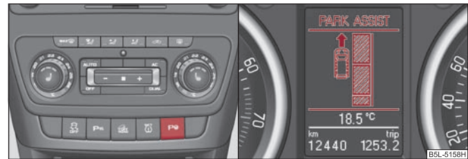
Изобр. 111 Включение ассистента постановки на стоянку / информационный дисплей: поиск подходящего промежутка для постановки на стоянку
