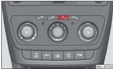
Изобр. 104 Кнопка для непосредственного включения (выключения) независимого дополнительного отопителя и вентиляции на панели управления устройством Climatic
