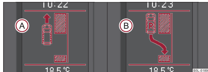
Изобр. 112 Информационный дисплей: промежуток для постановки на стоянку выявлен с указанием для продолжения движения автомобиля вперед (A) и для включения заднего хода (B)
